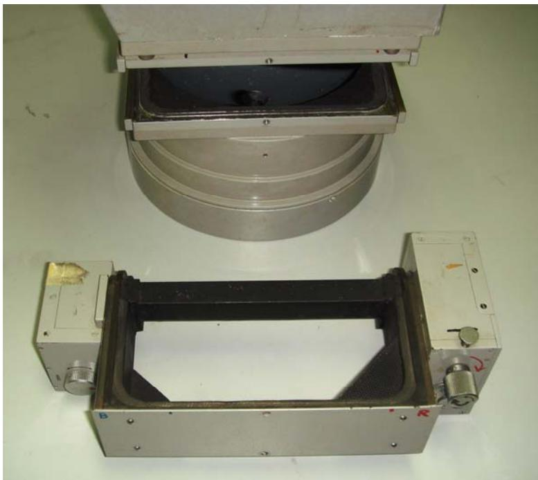
写真11 フィルム装填部を抜いたところ
