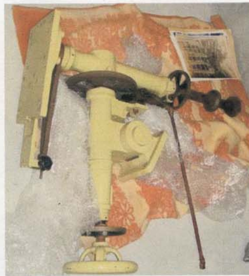
写真4 望遠鏡柱状部。写真5 赤経赤緯軸及び望遠鏡取付台部分。
