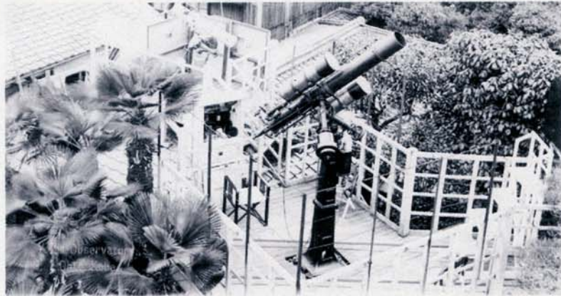
写真3 6吋屈折赤道儀（天体写真儀）。
