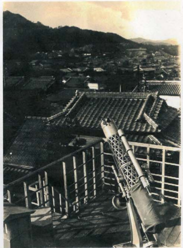
写真2 12吋反射赤道儀。
