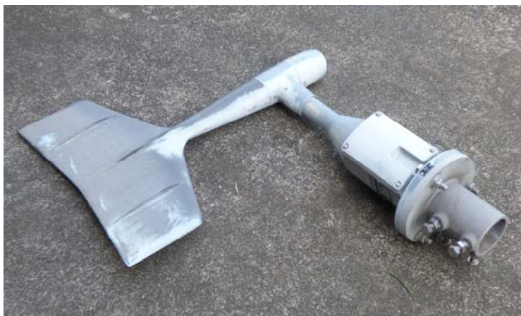
写真 6 回転翼が吹き飛んだ風向風速計
