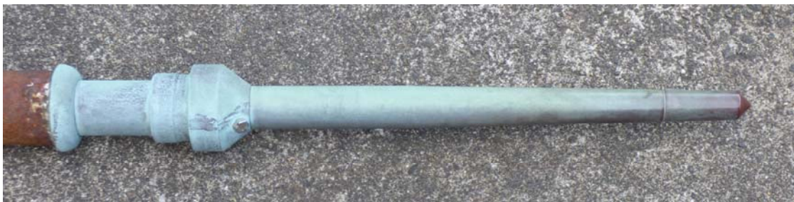
写真9 避雷針の先端部
