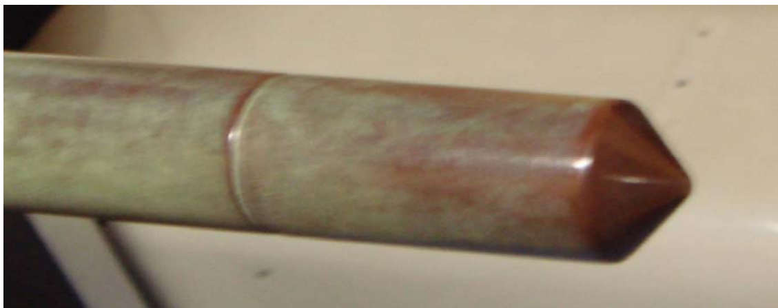
写真 10 先端が磨いたように見える避雷針
