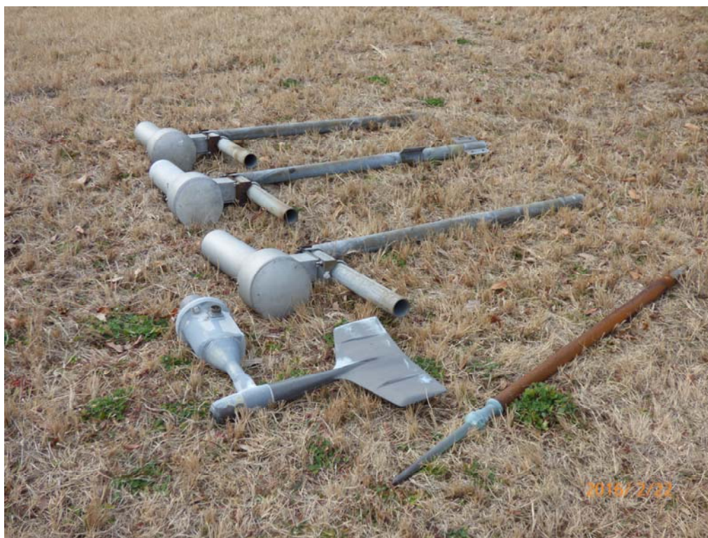
写真 1 鉄塔から外された温度センサー、風向風速計、避雷針
