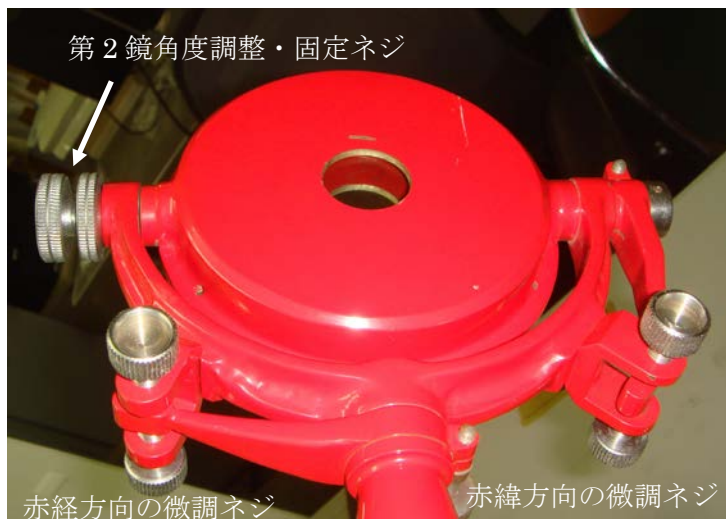
写真11 赤経・赤緯方向の微調機構
