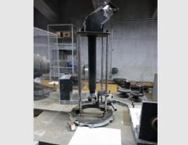
解説・備考 これは、65cm屈折望遠鏡で恒星のスペクトル型分類を始めた大沢清輝教授が製作した分光器である。この分光器は基線尺倉庫と呼ばれている建物が、古い機器の倉庫になっている中から発見したものだ。光学系は完全に残っている。この分光器を製作した大沢教授は分光部の部長だった。その分光部があった建物(本館二階)から、この倉庫に運び込んだ記憶がある。使われなくなった観測機器の部品が完全に残るケースはむしろ珍しいことである。
