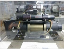
解説・備考 赤外分光計をはじめ、光吸収スペクトルを得るためには、光をプリズム等を使っているいろいろな波長に分離して検出する、分散型分光計が主流であった。しかし最近ではマイケルソン干渉計を使って光を検出し、そのデータをフーリエ変換してスペクトル化するのがフーリエ変換赤外分光計 (FT-IR: Fourier Transform Infrared spectrometer) である。
