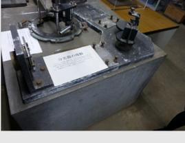
解説・備考 これは、分光器の残骸である。この分光器室を掃除するとき、分光器の木製の暗箱は腐ってボロボロだったので捨てた。木製の暗箱の中に光学部品はすでに何もなかった。金属部分だけを残して展示してある。
