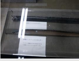
解説・備考 曲がっている方は、スペクトル撮影のために収差に合わせて曲線にしたフィルムホルダーである。
