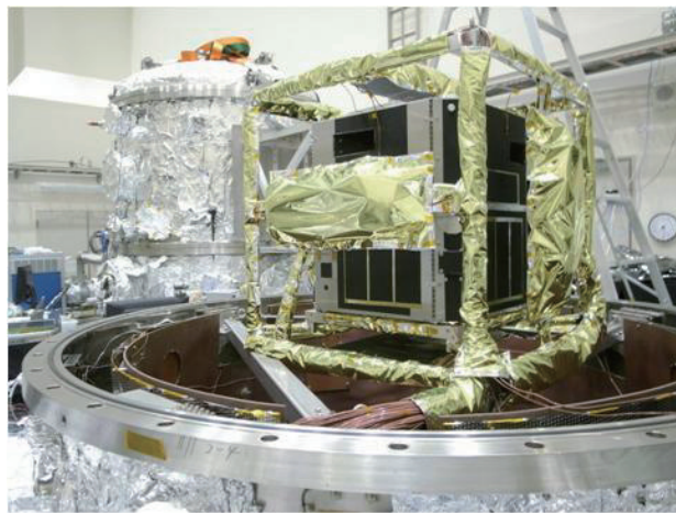
図 2. Nano-JASMINE の熱構造モデルの外観。国立天文台の熱真空チャンバーに設置されている。衛星の周りには軌道上の熱環境を模擬するためのヒーターが取り付けられている。
