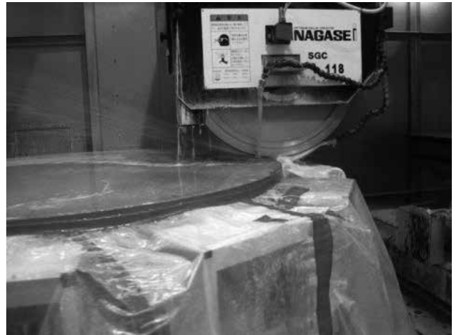
図4. 主鏡分割鏡の非球面研削加工。
