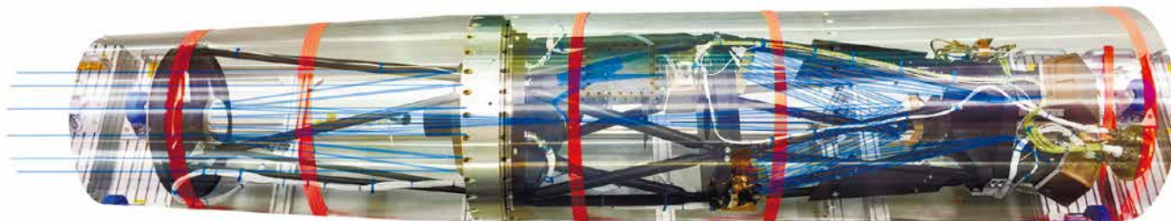
図2. 組み上がったCLASPの観測装置。打ち上げ時、観測装置はロケットのスキン (写真で半透明に写っている筒) に覆われる。写真には、光路を青線で描いた。
